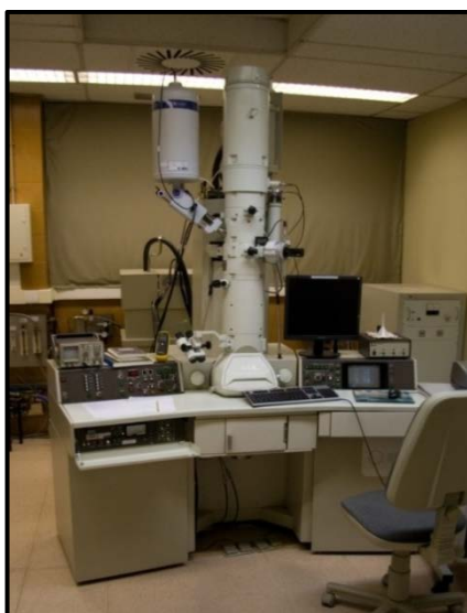
Figura 3.5. Microscopio de transmisión electrónica de alta resolución JEOL-2000 FXII con analizador de rayos X dispersados INCA 200 de Oxford instruments.
