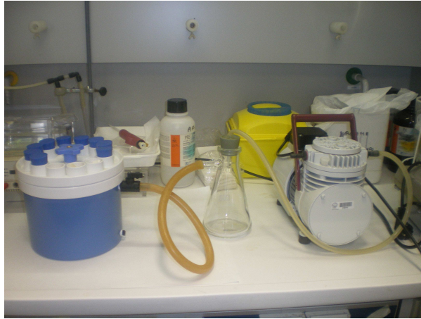
Fig. 4. Equipo de filtración.
