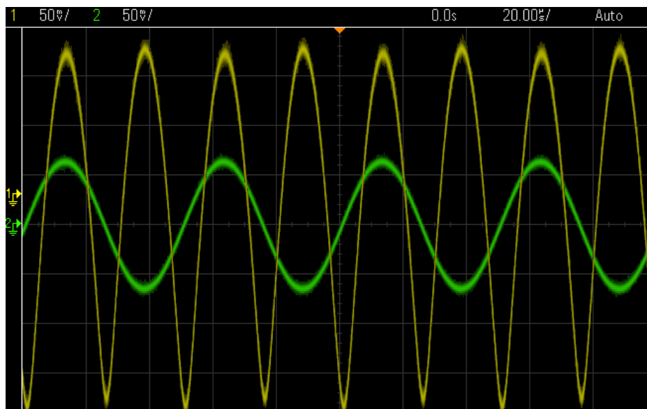
FIGURA 57. TENSIÓN DE ENTRADA Y SALIDA DEL GREEN RINGER PARA F=20kHz Y IN=0.2VPP . CUADRICULA DE 20MS EN EJE X Y 50MV EJE X
