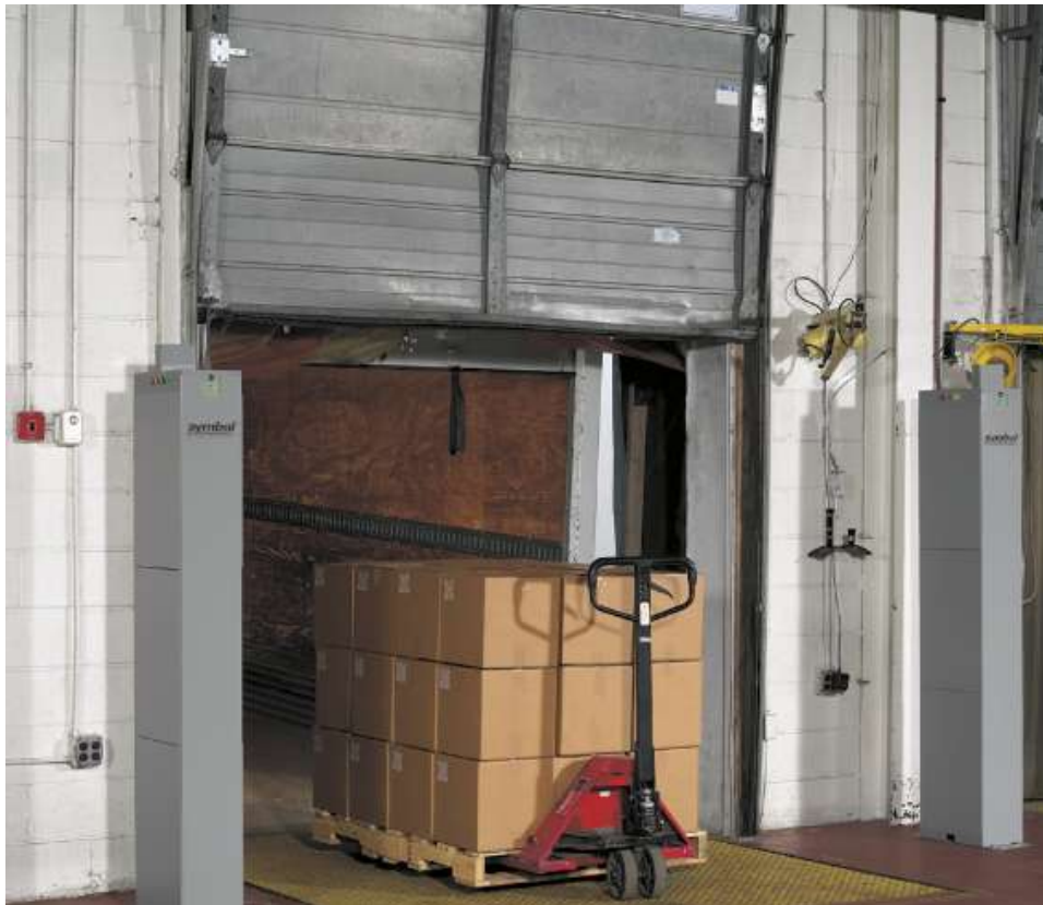
Ilustración 2. Sistema RFID real con arco de lectura
