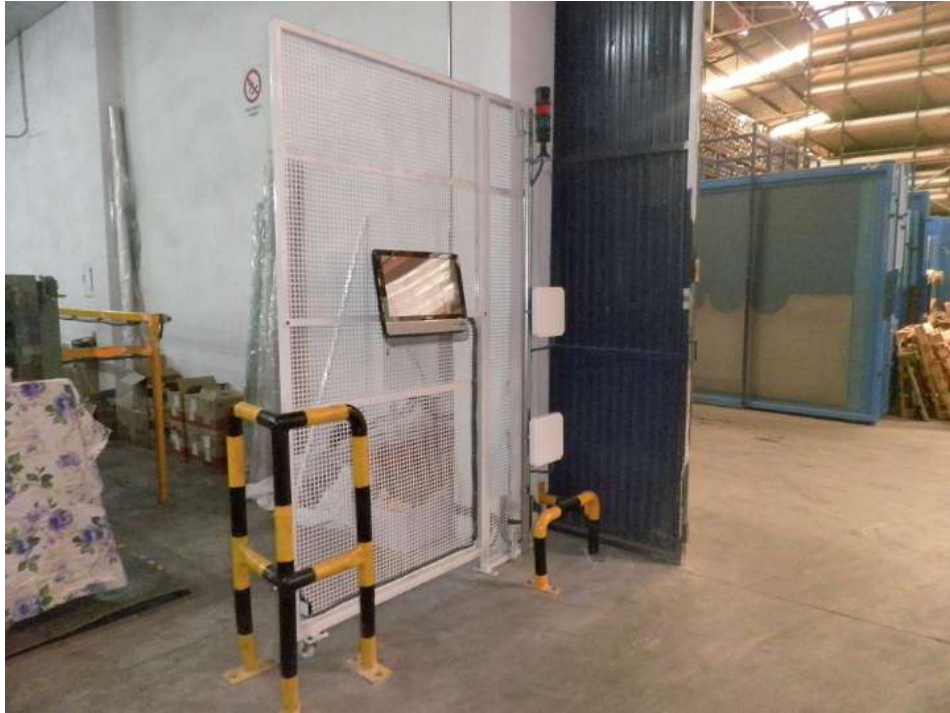
Ilustración 1. Imagen de un sistema RFID real con 2 antenas
