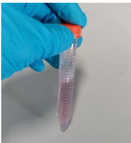
Imagen 4-5. Izquierda: Nanorods en disolución de CTAB. Derecha: pellet de nanorods.
