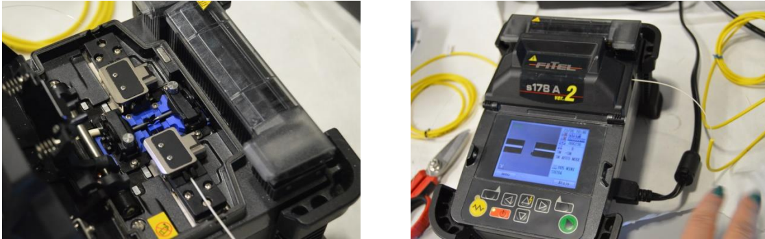
Imagen 7-4. Empalmadora S176 de Fitel. Izquierda: Interior de la máquina con dos fibras alineadas. Derecha: Máquina fundiendo ambos extremos cortados de las fibras.
