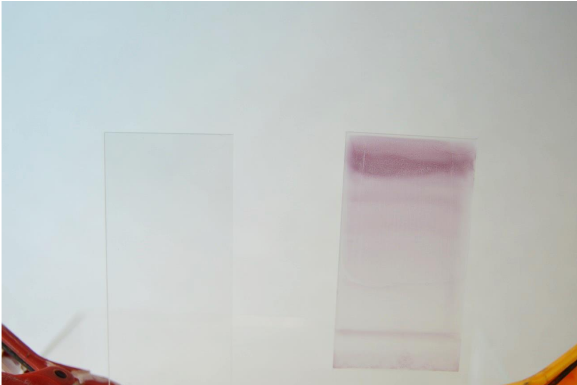
Imagen 5-2. Izquierda: recubrimiento [PAH (4.6)/AuNRs@PAA (8)] 100 . Derecha: [PAH (4.6)/AuNRs@Pss (5.47)] 100 .
