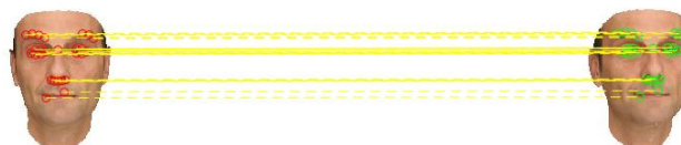
Figura 3.19. Ejemplo de funcionamiento de RANSAC para el usuario 8 de la base de datos sintética. Arriba, los 43 puntos de entrada al algoritmo de RANSAC. Abajo, discriminación de puntos establecida por este método a su salida.
