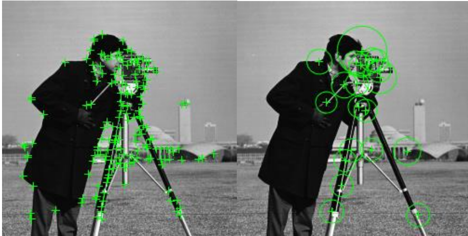
Figura 1.10. A la izquierda, detección de puntos SURF en una imagen. A la derecha, detección de puntos BRISK.
