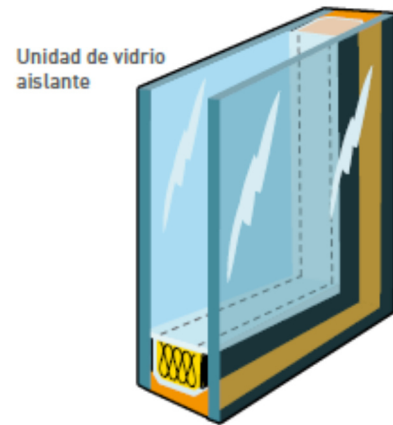
Figura 37: Unidad de vidrio aislante. IDAE. Guía de recomendaciones de eficiencia energética.
