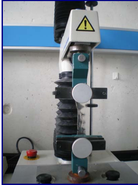
Figura (4): texturómetro Texture Analyzer TA-XTZi (Surrey, Gran Bretaña), utilizado para la caracterización de las propiedades mecánicas del presente estudio.
