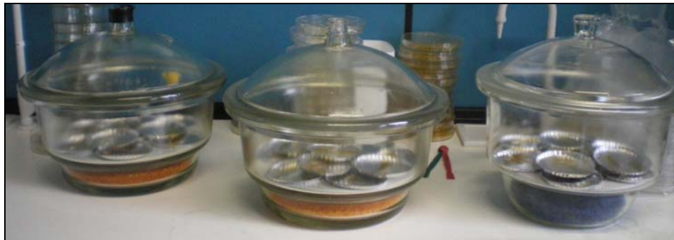
Figura (20): Cabinas con sílica gel mantienen 0% HR en su interior.
