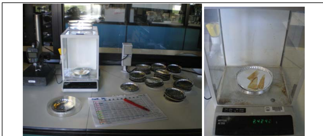
Figura (22): En la imagen cada platito de aluminio con las diferentes tiras en el momento de pesarlas.
