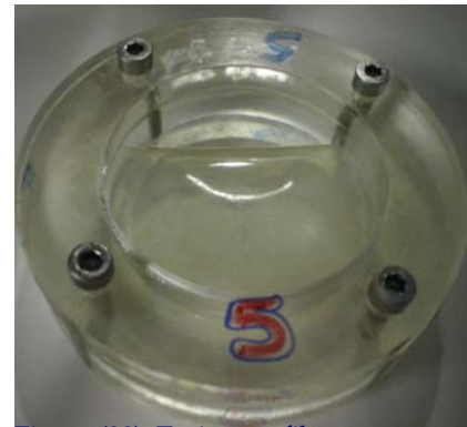
Figura (28): Tacita con film roto
