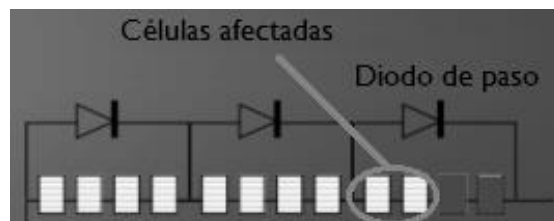
Figura 2.12 Células afectadas por sombras parciales
