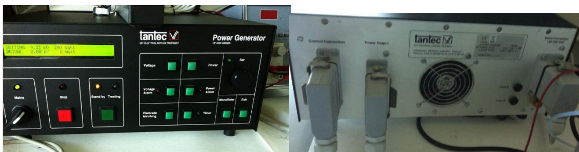
Imagen 15: Generador de tensión TANTEC “PowerGenerator HV 2000”
