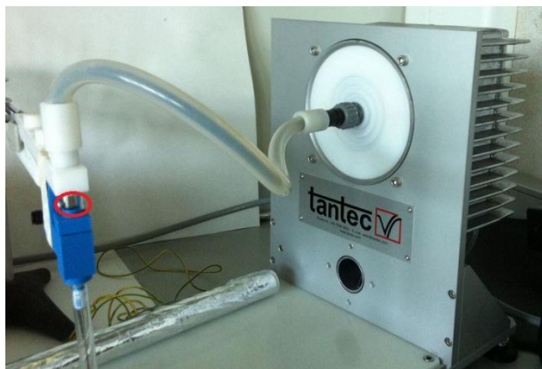
Imagen 16: Transformador de tensión TANTEC.
