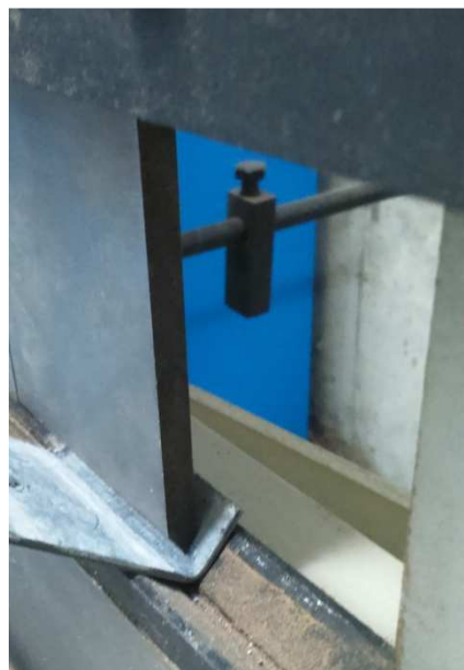
Imagen 60. Doblado de chapa de acero galvanizado.
