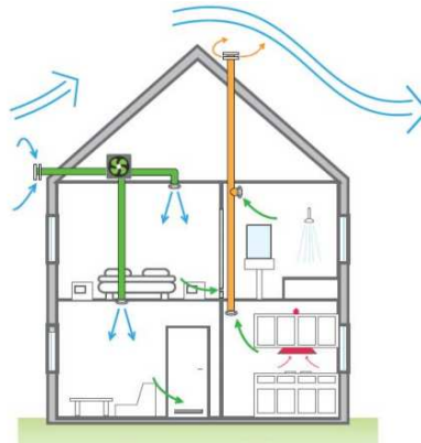
Imagen 3. Ventilación con admisión mecánica y extracción natural.
