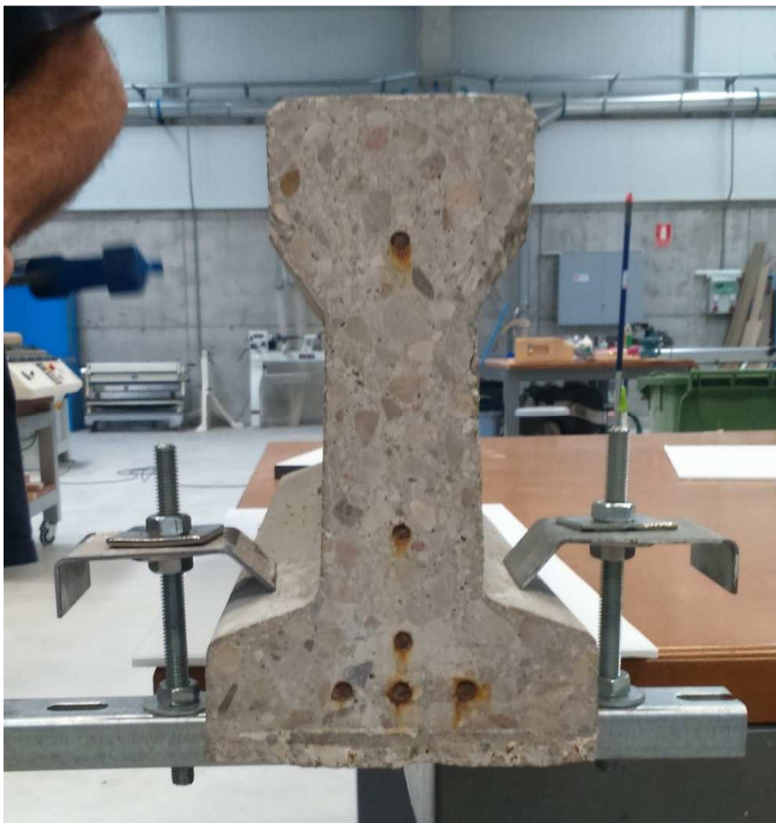
Imagen 64. Sistema de sujeción sobre perfil de hormigón pretensado.
