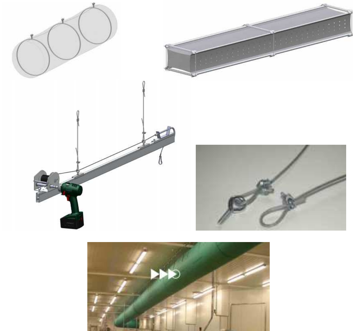
Imagen 40. Suspensión de tubería por cable.
