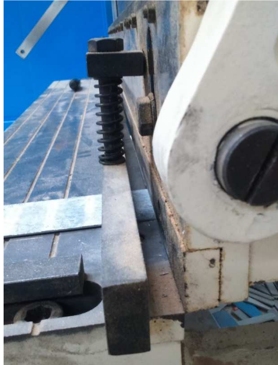
Imagen 59. Corte de chapa de acero galvanizado.
