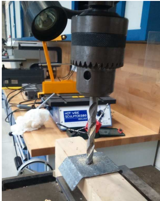
Imagen 61. Taladro de 8mm de diámetro en chapa.
