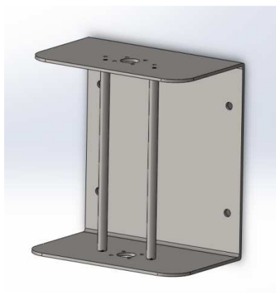
Figura 39. Montaje de las guías en el soporte
