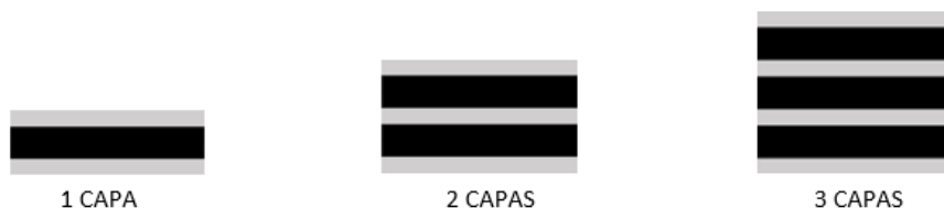
Figura 53. Representación del aumento de porcentaje de fibra con el número de capas
