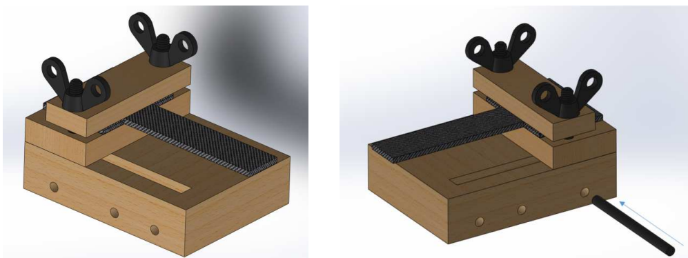
Figura 60. a) Diseño del soporte para el voladizo
