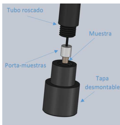
Figura 62. Esquema del cambio de la muestra
