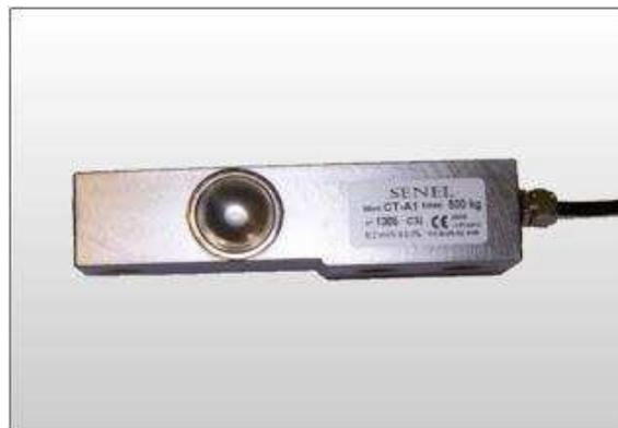
*Ilustración 21: Célula de cortadura simple*
