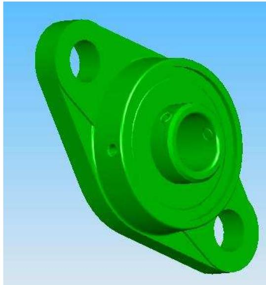
*Ilustración 38: Soporte de rodamiento*
