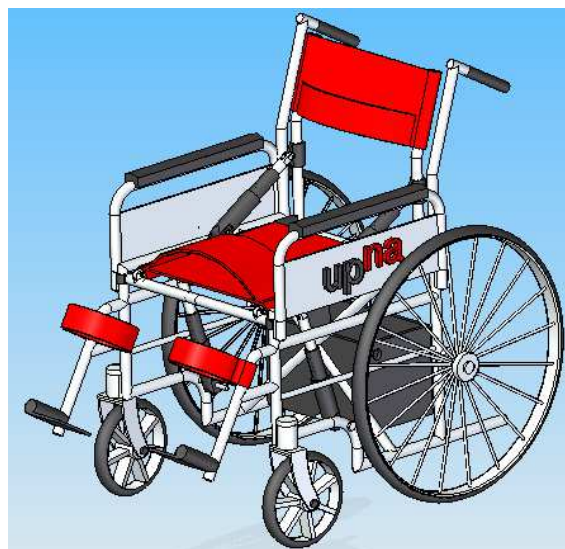
6.6.11 En esta imagen podemos ver el sistema instalado además de las tiras de sujeción para las piernas del usuario.
