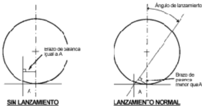
Fig. 5.8 Un lanzamiento positivo reduce el par autoalineante para un valor determinado de avance.
