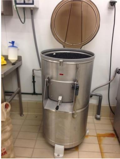
**Ilustración 5. Equipo de pelado por abrasión**
