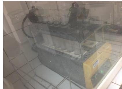
Ilustración 28. Digestor Kjeldahl en la campana extractora
