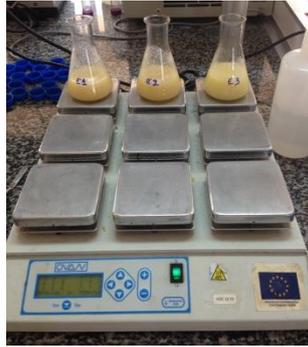
Ilustración 22. Agitador magnético con calefactor
