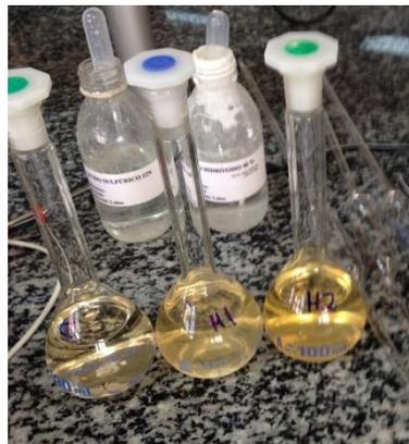
Ilustración 24. Matraces aforados con extracto acuoso y anaranjado de metilo
