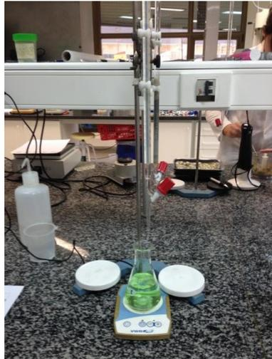
Ilustración 30. Valoración ácido base
