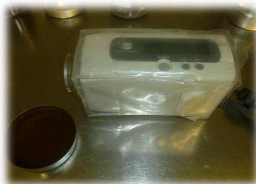
**Figura 7. Colorímetro empleado para la determinación de las coordenadas  $L^*$ ,  $a^*$  y  $b^*$ .**
