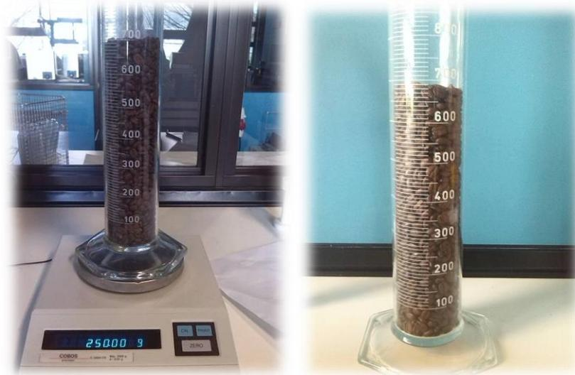
**Figura 6. Imagen izquierda: peso de los granos de café y volumen que ocupan en la probeta de un litro. Imagen derecha: detalle del volumen ocupado por los granos de café.**
