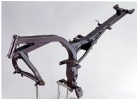
Figura 4.22-Chasis de espina central
