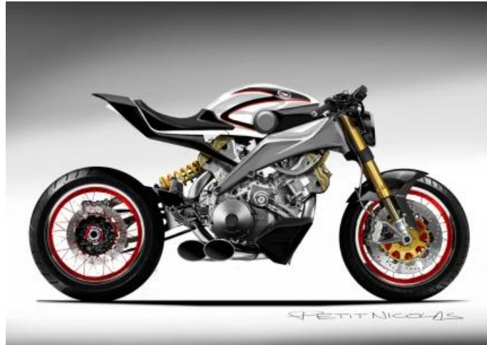
Figura 4.27-Diseño de Nicolás Petit, motor estructural
