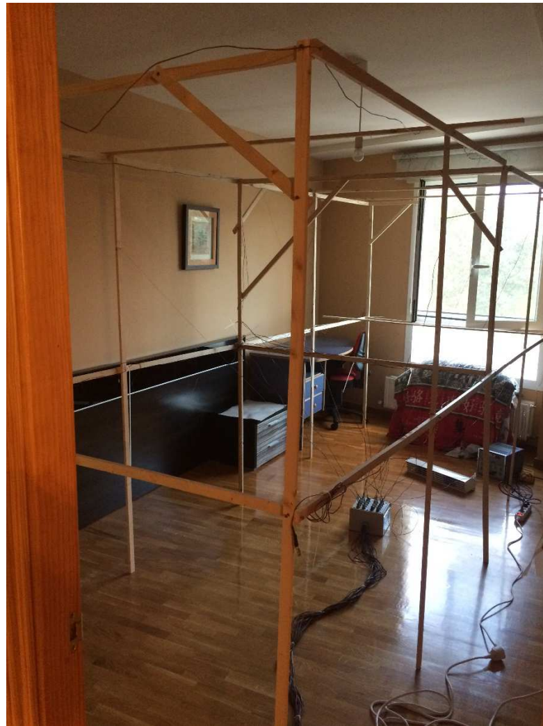
Figura 71. Habitación empleada para las pruebas térmicas con la estructura de soporte para las sondas
