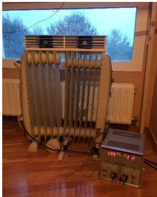
Figura 73. Radiadores eléctricos de aceite con el DAREC encima y la fuente de alimentación empleada
