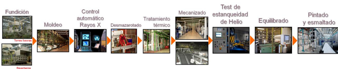
Figura 4. Esquema del proceso productivo para la fabricación de llantas en Mapsa.
