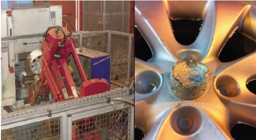
Figura 11. Robot de la célula de desmazarotado colocando una llanta en la máquina de taladro (izquierda) y la mazarota de la llanta (derecha).
