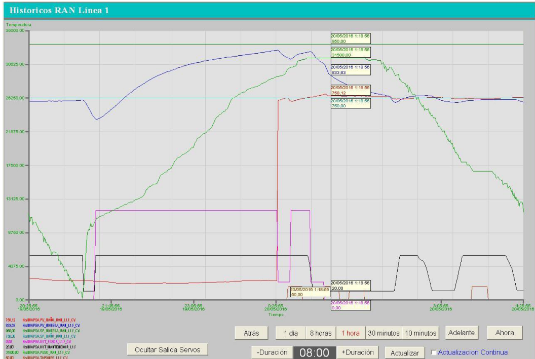
Figura 23. Registro actividad reverbero 1. En verde el peso de aluminio, en rosa el quemador fusor, en negro el quemador mantenedor, en azul la temperatura de la bóveda, en rojo la temperatura del caldo y en marrón los ciclos de agitación de los tapones porosos.
