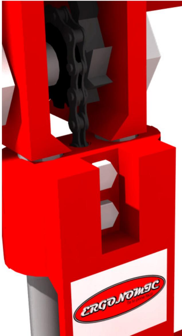
El diseño que hemos planteado ha consistido, en utilizar componentes utilizados en las bicicletas., tanto la cadena como el engranaje. Si en su día tomamos esta decisión, fue para simplificar al máximo el diseño, para facilitar los cálculos y reducir el precio del producto final.
