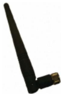
Figura 4.10. Antena mini para interiores
