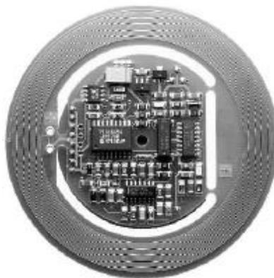
Figura 3.23.Lector de acoplamiento inductivo
