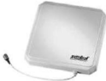
Figura 4.9. Antena de panel
