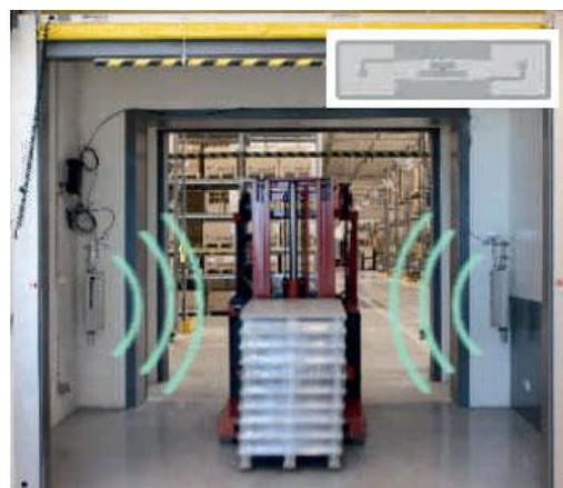
Figura 1.3. Sistema RFID que identifica los palets que cruzan la puerta
