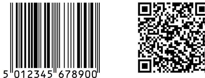
Figura 3.12. Código de barras unidireccional y bidireccional
