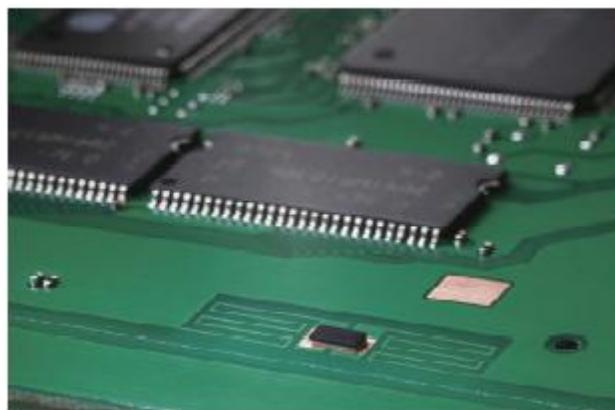
Figura 3.25.Tag de acoplamiento inductivo
