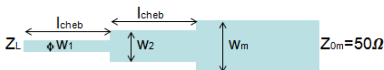
Figura 3.3: Esquema general del Transformador de impedancias de 2 secciones Chebyshev.
