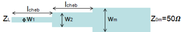
Figura 2.17: Esquema general del Transformador de impedancias de 2 secciones Chebyshev.
