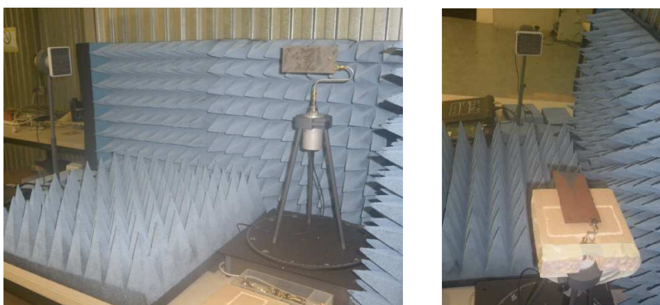
Figura 4.6: Sistema de medición para el plano H y plano E de las antenas Vivaldi elementales fabricadas, para 9.5GHz.
