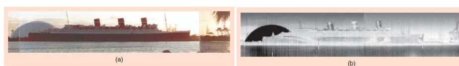
Figura 1.6: a) Visible y b) PMMW imágenes del Queen Mary y la antigua cúpula de Spruce Goose en el puerto de Long Beach, California.
