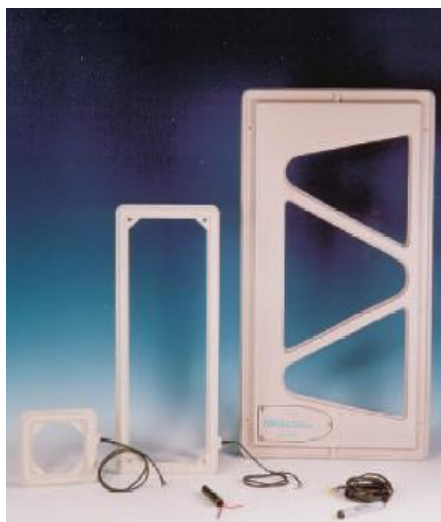
Figura 2.30. Antenas de baja frecuencia
