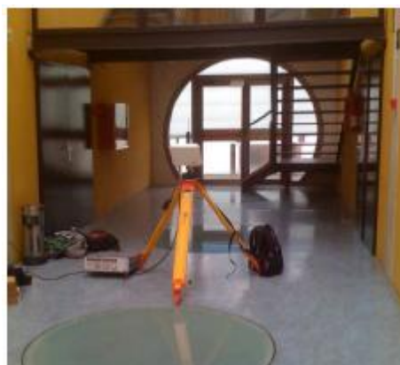
Figura 3.1. Antena de panel conectada al generador lista para transmitir en el pasillo de los Tejos
