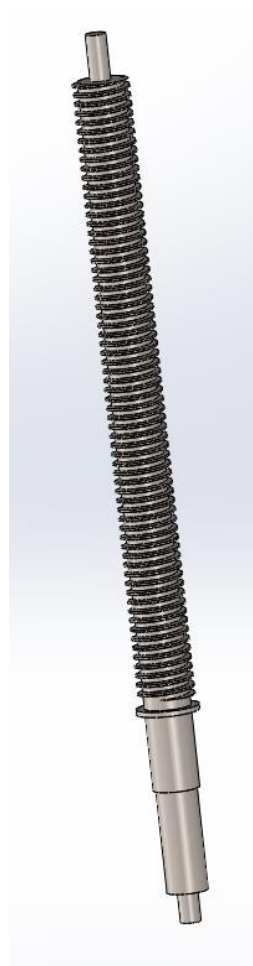
Fig.4.2: captura del husillo sinfín diseñado
