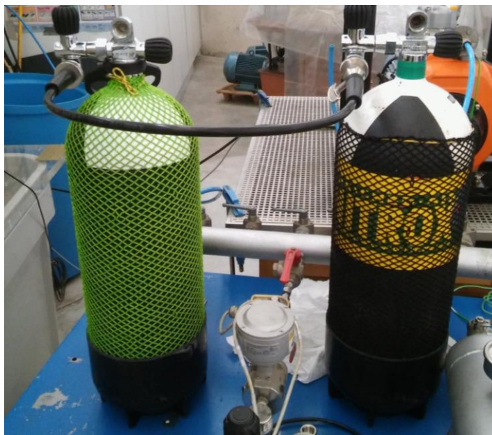
Figura 36. Conexión de 2 bombonas para el ensayo
