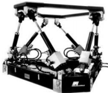
Figura 6. Ejemplo de robot paralelo de 6 GDL (hexápodo)
