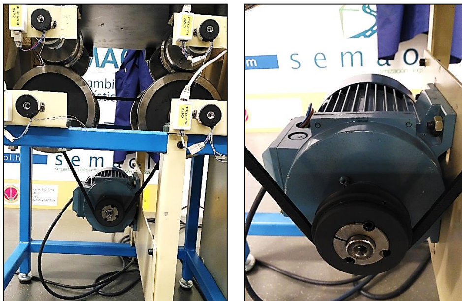
Figura 2.18. Sensores (izquierda). Motor eléctrico y sistema de transmisión (derecha). Fotografía.
