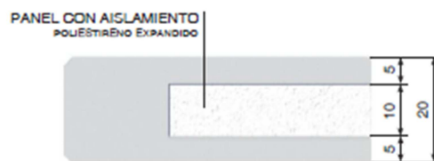
Figura 9: Panel de Hormigón
