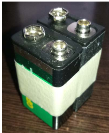
Figura 55. Pilas en paralelo.
