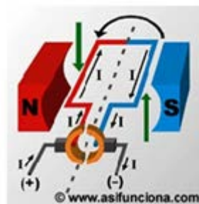
Figura 27. Una espira funcionando como generador. Fuente
