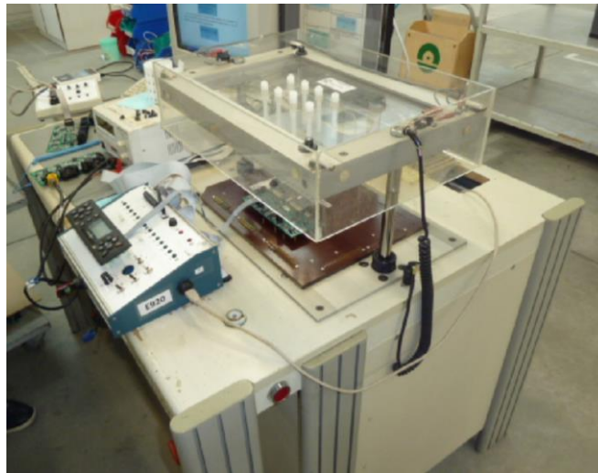
Figura 6 - Verificador en mesa neumática.
