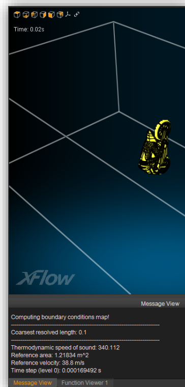
Figura 19: orientación y área de referencia obtenida al importar la moto a Xflow™
