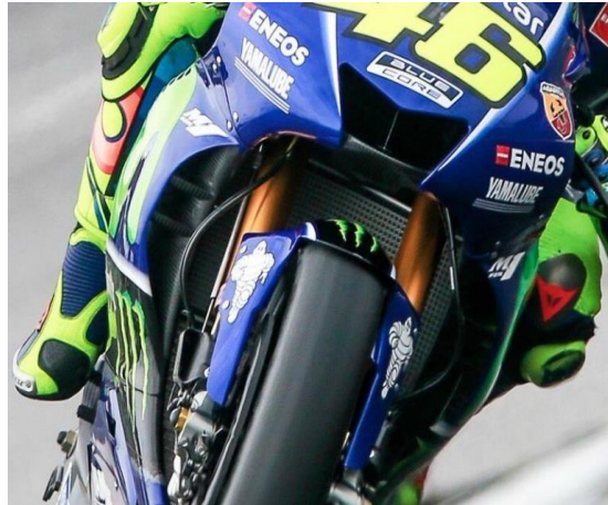
Figura 10: vista del carenado de Yamaha™ con alerones interiores
