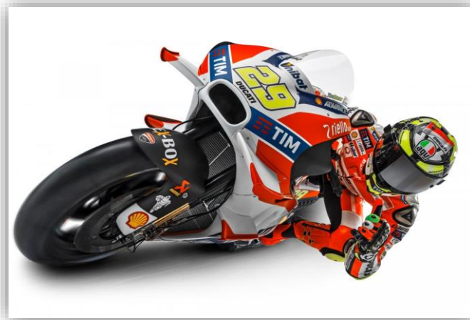
Figura 8: alerones implantados en el carenado de la Ducati™ Desmo16 GP
