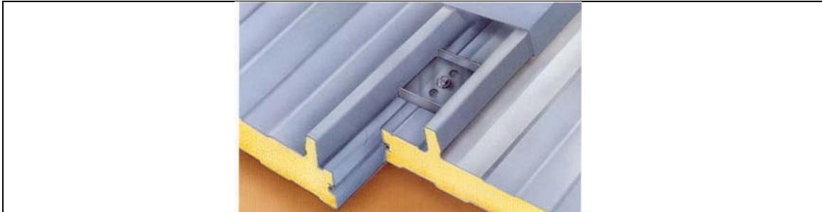
Se fabrica en una línea en continuo donde las caras exterior e interior son perfiles formados en frío. El aislamiento de poliuretano expandido se inyecta entre las dos caras para un espesor predeterminado, formando un conjunto compacto y totalmente integrado. A continuación el panel se corta a la longitud deseada.
