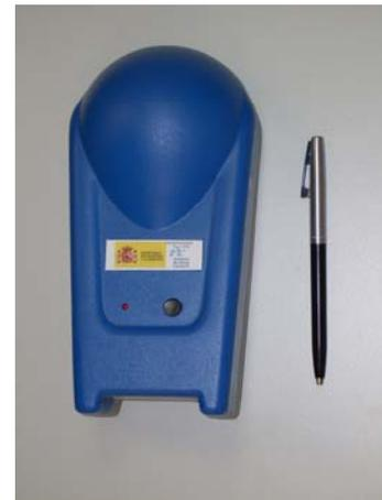
Fig. 6. Equipo de medida empleado para el cálculo de dosimetría (ANTENNESSA EME SPY 120)
