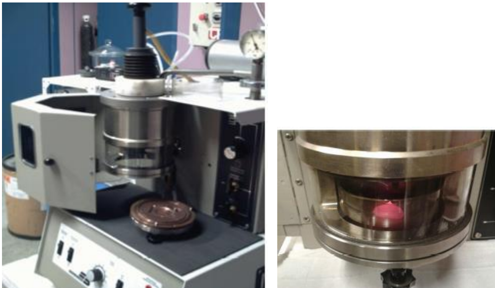
Figura 2.2: A la izquierda, horno de arco empleado en la elaboración de la aleación. A la derecha, fotografía de la pastilla elaborada tras uno de los procesos de fusión.
