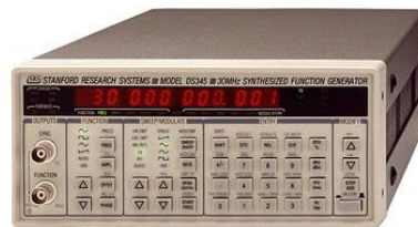
Figura 2.11: Imagen del Generador de Funciones modelo DS345 utilizado para realizar las mediciones.
