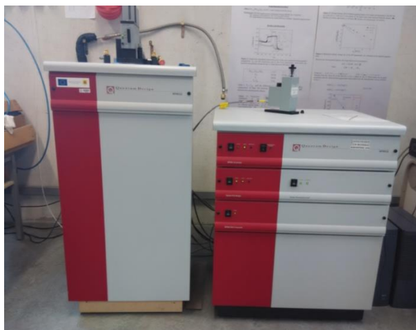
Figura 2.7: Magnetómetro SQUID Quantum Design MPMS XL-7. A la izquierda, el criostato. A la derecha, el controlador de temperatura.
