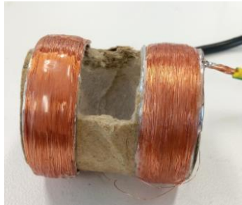
Figura 3.12: Bobinas de 500 vueltas cada una conectadas en serie situadas en un soporte de cartón.
