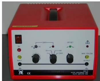
Figura 2.13: Imagen del Amplificador modelo Leybold 52261, utilizado para realizar las mediciones.
