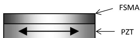
Figura 1.12: Ilustración de un composite laminar que combina el efecto magnético de la FSMA y el efecto eléctrico del PZT.
