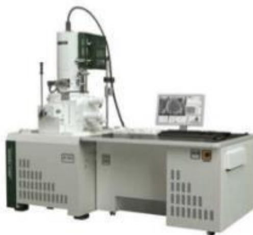
Figura 2.4: Microscopio electrónico de barrido JSM-5610LV del Servicio de Apoyo a la Investigación (S.A.I).
