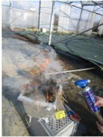
Figura 8: proceso de quema de las macetas con el soplete portátil.
