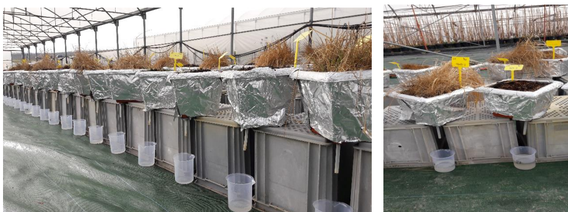
Figura 10: proceso de recogida de los lixiviados.
