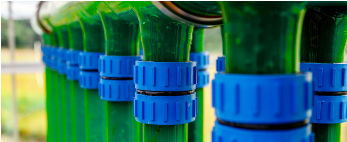
Tubos de cristal con racores para fotobiorreactor tubular de la marca Schott (fotografía de la empresa)
