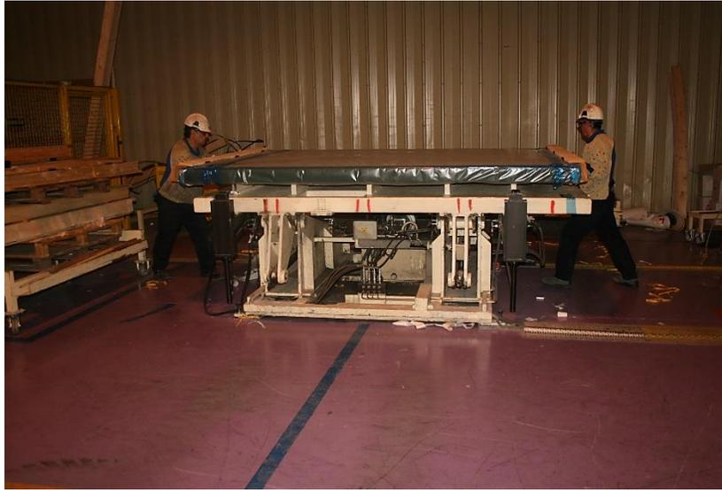
Figura 21. Detalle de la colocación de los costados de madera al vidrio por los dos operarios.
