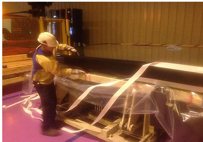
Figura 19. Colocación del plástico azul protector.
