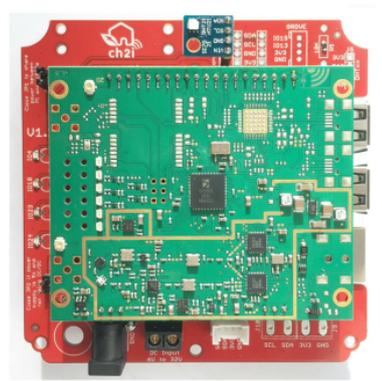
Figura 1.5: Raspberry Pi con módulo iC880
