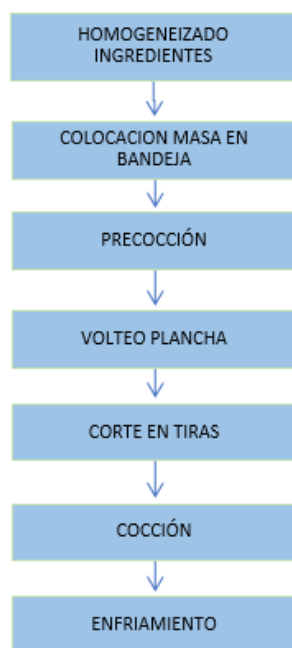
Figura 9. Diagrama de flujo planchas
