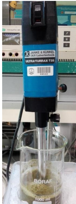
Figura 19. Homogeneización del hinojo marino con el Ultraturrax T25 IKA-WERKE
