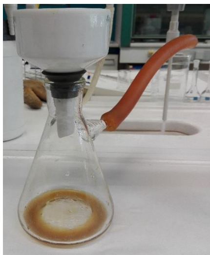
Figura 23. Filtrado a vacío de los extractos obtenidos del rotavapor tras resuspenderlos en 30 ml de agua destilada
