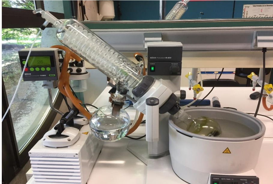
Figura 22. Secado de los extractos de hinojo marino en el Rotavapor Buchi R-200, acoplado a módulos de vacío V-805
