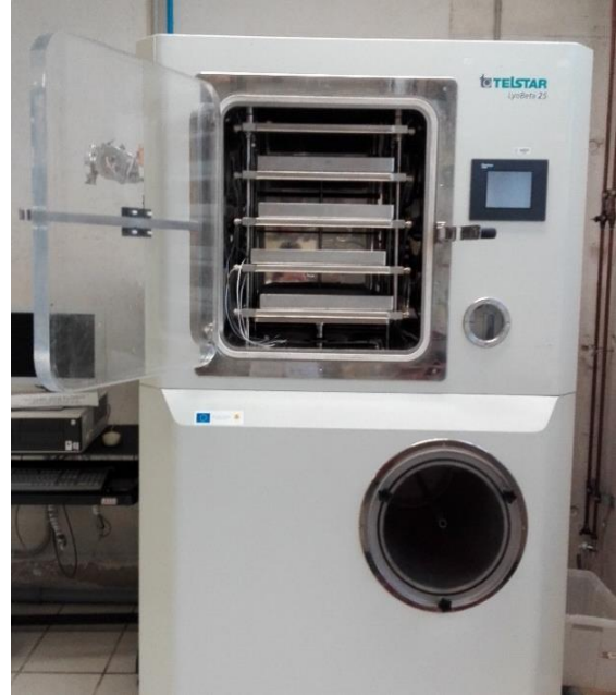
Figura 18. Liofilizador semiindustrial Lyobeta 25
