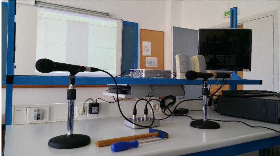
**Fig. 14 Montaje para la medición de la velocidad del sonido en el aire**
