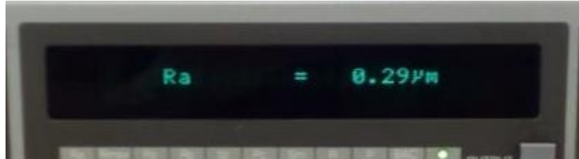
Imagen 29 - Verificación rugosidad exterior de una tuerca
