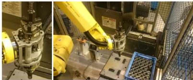
Imagen 13 - Robot de carga y descarga. Detalle pinzas
