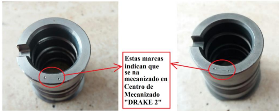
Imagen 30 - Detalle de las marcas de las máquinas fresadoras DRAKE
