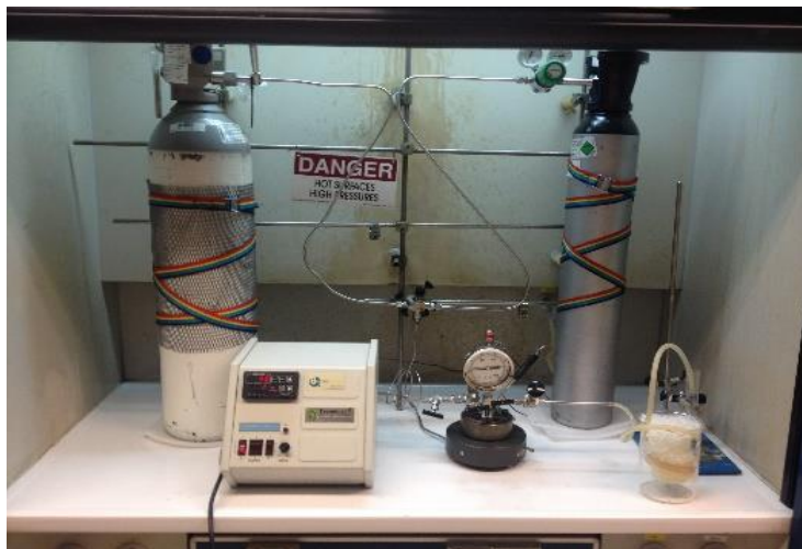
Imagen 3.3.2.1. Montaje empleado durante el secado de una muestra, se emplea un vaso enfriado con agua o hielo para condensar los vapores de disolvente y recogerlos en una probeta graduada.
