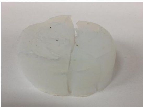
Imagen 4.1.1. Aspecto de un aerogel preparado por secado en condiciones supercríticas de etanol por el procedimiento directo.
