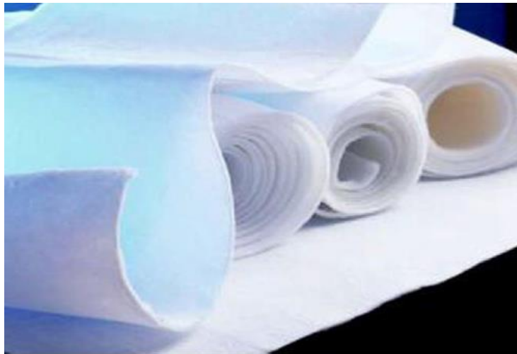
Imagen 1.4.2.1. Manta de aislante fabricada por Aspen Aerogels, está formada por una estructura de aerogel intercalada por fibras orgánicas. Tomado de [60].
