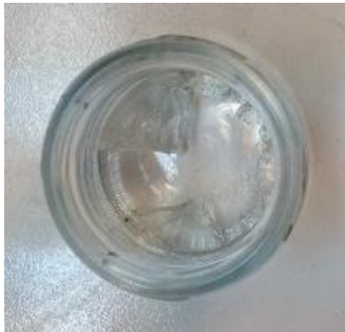
Imagen 4.2.2. Aspecto de un aerogel obtenido por secado en condiciones supercríticas asistidas por dióxido de carbono.
