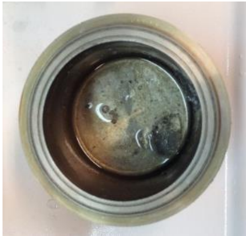
Imagen 4.2.1. Aspecto del gel tras un intento de secado con dióxido de carbono; se observa la presencia de disolvente en el reactor.
