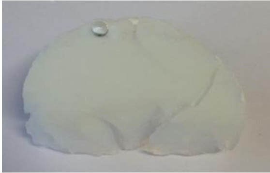
Imagen 4.4.1. Caracterización del carácter de la superficie de dos muestras; (a) aspecto de una gota de agua sobre la superficie de un aerogel preparado por secado directo en etanol; (b) aspecto de un gel preparado por secado directo en acetona tras ponerlo en contacto una gota de agua, la mancha en la parte inferior del gel es resultado de la absorción del agua por el aerogel.
