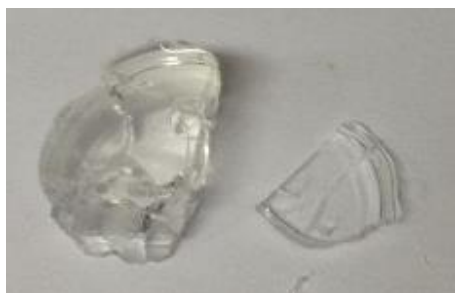
Imagen 4.3.1. Aspecto de un aerogel madurado en TEOS y secado en condiciones ambientales.
