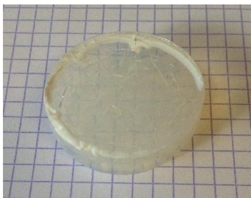
Imagen 4.1.2. Aspecto de un aerogel madurado en TEOS secado en condiciones supercríticas de etanol por el procedimiento directo.
