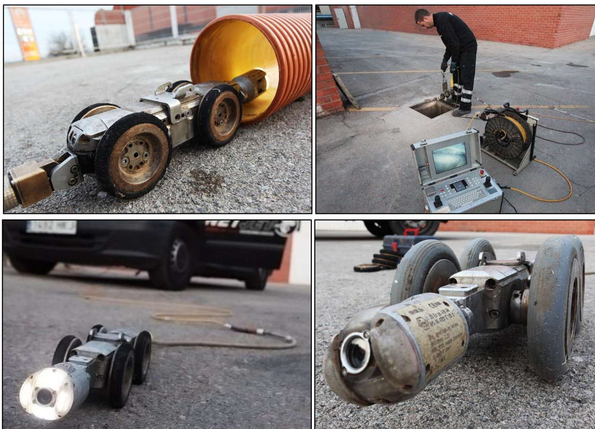
Figura 6. Sistema de grabación robotizado 2D. Fuente: (NetJet, 2017)
