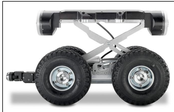
Figura 5. Robot con sistema de grabación IBAK Panorama. Fuente (IBAK, 2017)
