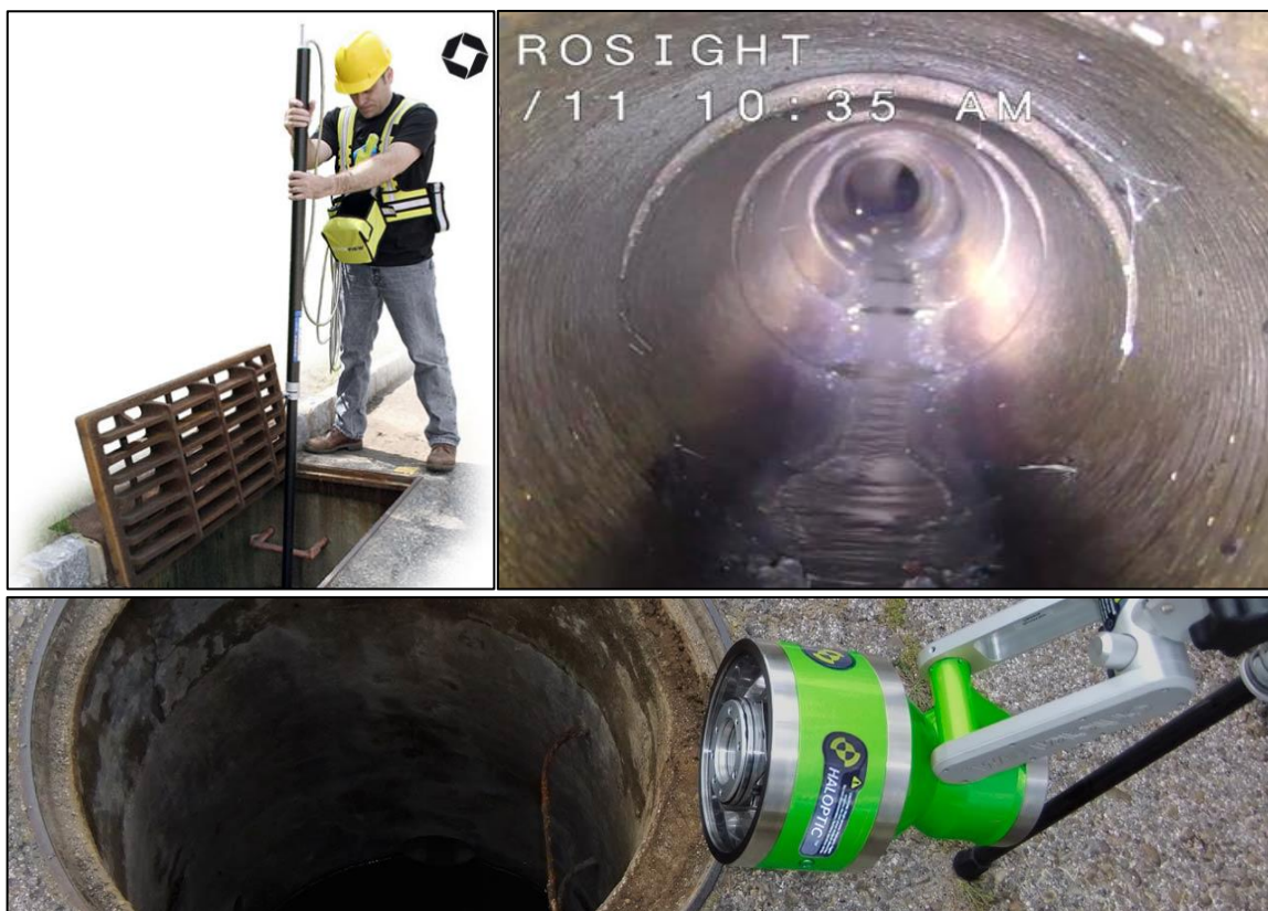
Figura 7. Sistema de pértiga telescópica con zoom. Fuente: (Panatec, 2017).
