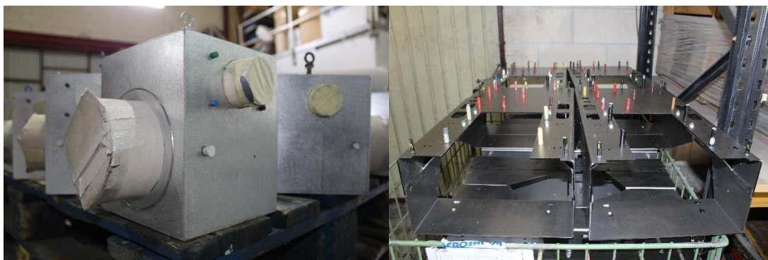
Figura 3: enmascaramiento de distintas piezas
