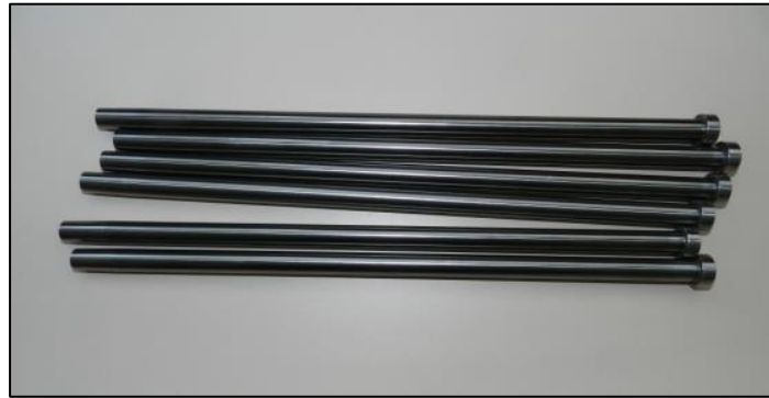
Figura 9.22: Insertos móviles utilizados para las pruebas de campo de inyección de aluminio con los recubrimientos CrAlON.
