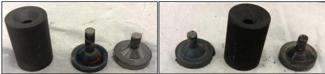
Figura 9.26: Molde de grafito y punzones de TZM recubiertos tras sinterizar Ti90Sn10 a 1100 °C (izqda.) y tras sinterizar Al 2 O 3 a 1300 °C (dcha.). En ambas imágenes el punzón de la izquierda es el recubierto con la multicapa CrAlN/CrAlO y el punzón de la derecha es el recubierto con el CrAlSiN monocapa.
