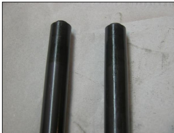
Figura 5.10: Insertos TiAlSiN tras 200.000 ciclos.
