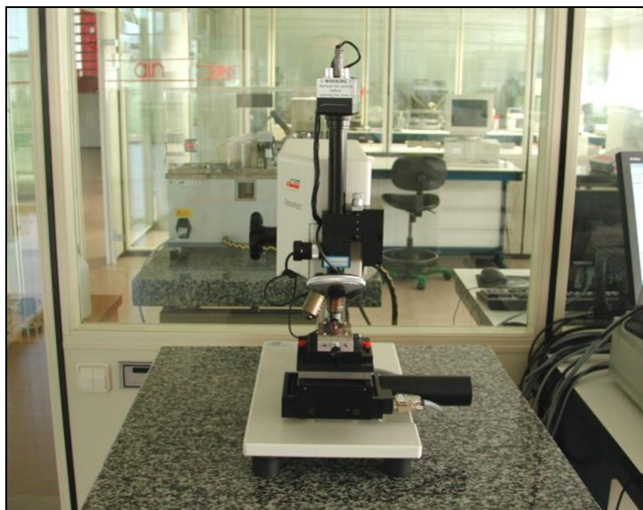
Figura 4.20: Equipo Revetest (CSM) utilizado para los ensayos de adherencia.
