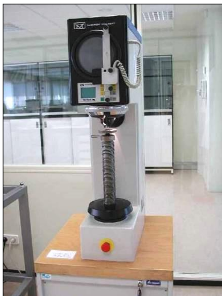
Figura 4.12: Durómetro multiescala de AIN empleado para las medidas de HRC.
