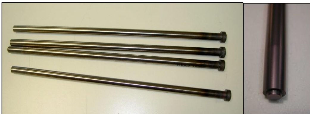
Figura 5.9: Machos o insertos móviles utilizados en procesos de inyección de aluminio (izqda.) y macho recubierto con TiAlSiN A (dcha.).
