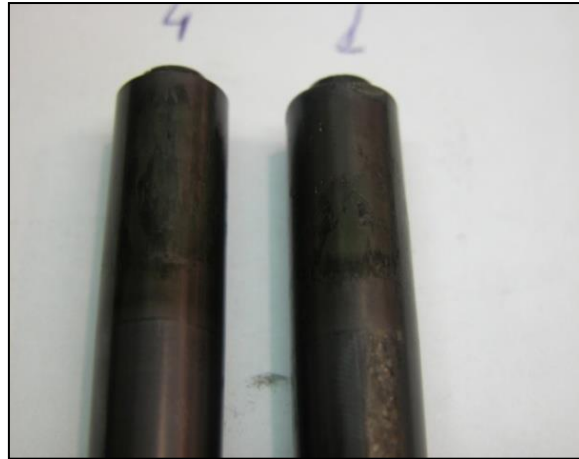
Figura 5.11: Dos insertos recubiertos tras las pruebas. Izqda: TiAlSiN A tras 375.000 ciclos. Dcha: AlTiN tras 175.000 ciclos.
