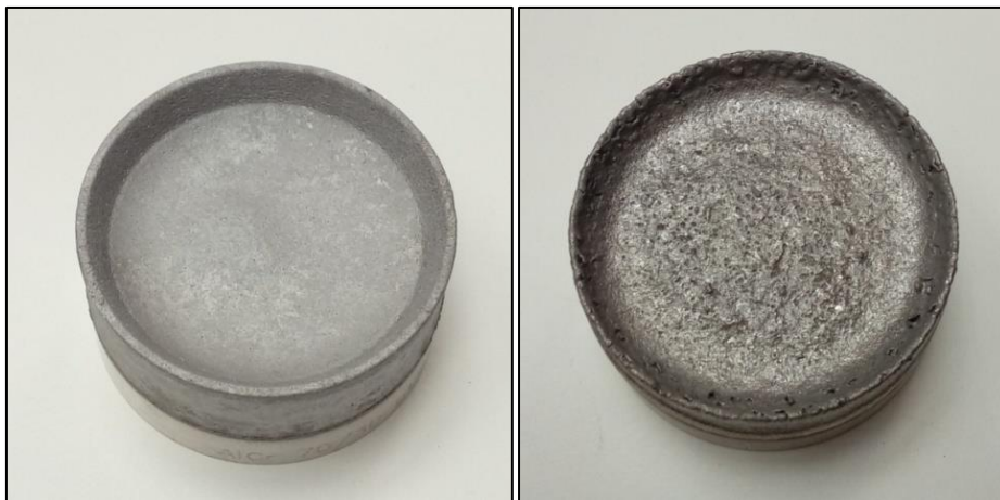
Figura 7.16: Cátodos de CrAl 30/70 tras un proceso con nitrógeno (izqda.) y tras un proceso con oxígeno (dcha.).
