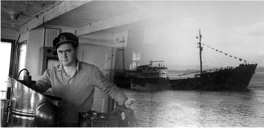
Juan Garavilla, capitán del "Sta. Elisa". Octubre 1956. A la dcha. el timón eléctrico. A la izda. la Bitácora, aquí va metido el Compás y la Brújula. Detrás de su cabeza está la Sonda (aparato para ver la profundidad)
