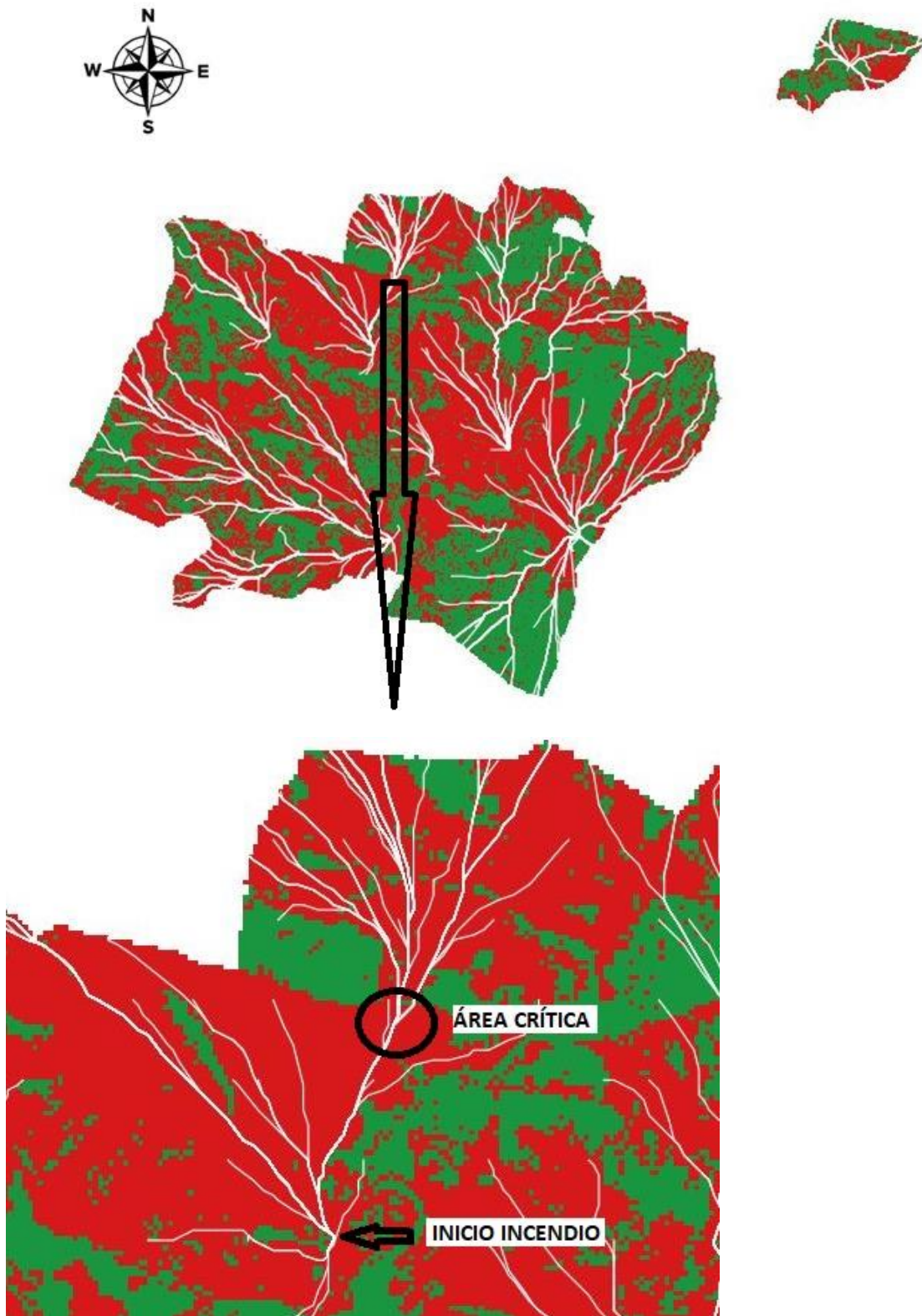
Figura 26: Área crítica establecida dentro de los términos municipales de Cáseda, Gallipienzo, Javier y Ujué. La imagen ampliada muestra el nodo a partir del cual se produce la ramificación del incendio en varias carreras. En color rojo se muestran las zonas que superan la capacidad de extinción y en verde las zonas que brindan oportunidad de extinción.
