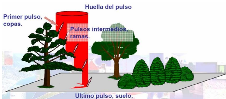
Figura 6: Huella del pulso láser. Fuente: Agresta S. Coop (2017).
