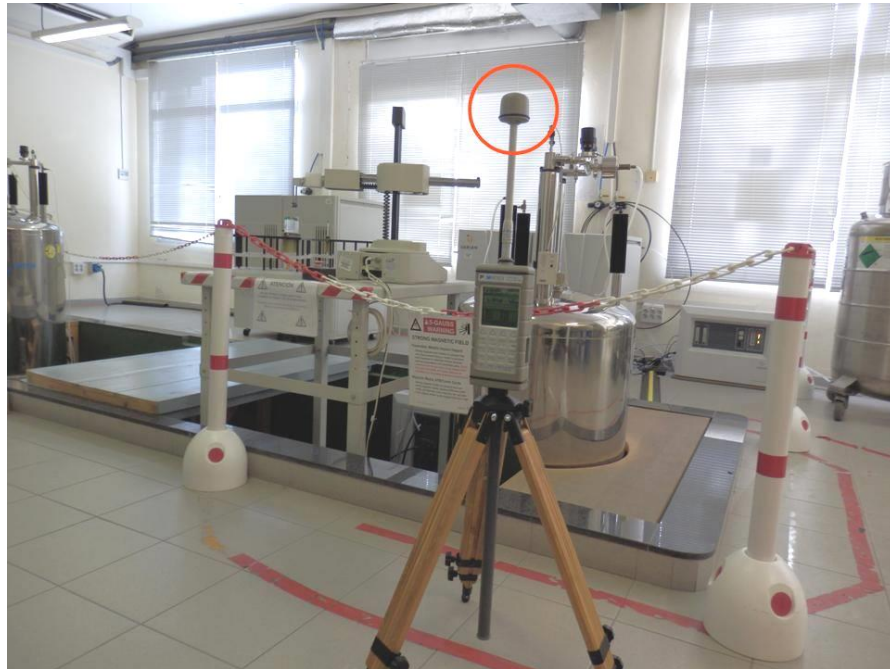
Figura FM8: Toma de valores ambientales de CEM RF, utilizando un monitor PMM8053 montado sobre un trípode de materiales no conductores (madera y teflón)
