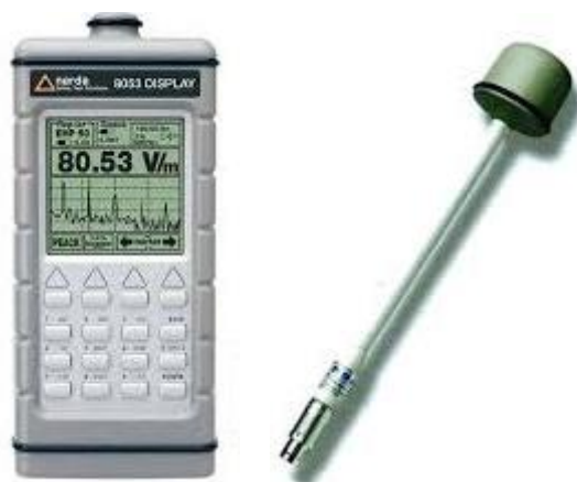
Figura FM1: equipo PMM8053, y sonda E-field probe para medición del componente eléctrico y cálculo del componente magnético de CEM RF
