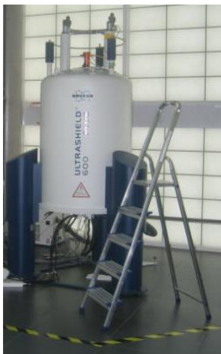
Figura FD6: Espectrómetro ultraapantallado, con la línea de contorno de B \geq 0,5 mT marcada en el suelo, para prevenir riesgos de disfunción de implantes activos debidos a la proximidad de sus portadores al equipo.
