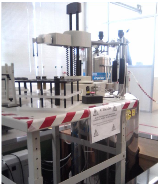
Figura FD1: brazo robotizado para la inserción de la muestra en un espectrómetro ubicado en foso.
